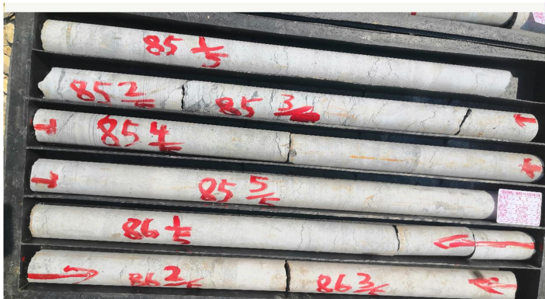
张夏组第三段 ZK202 钻孔岩芯照片（孔深 223m~227.6m）
