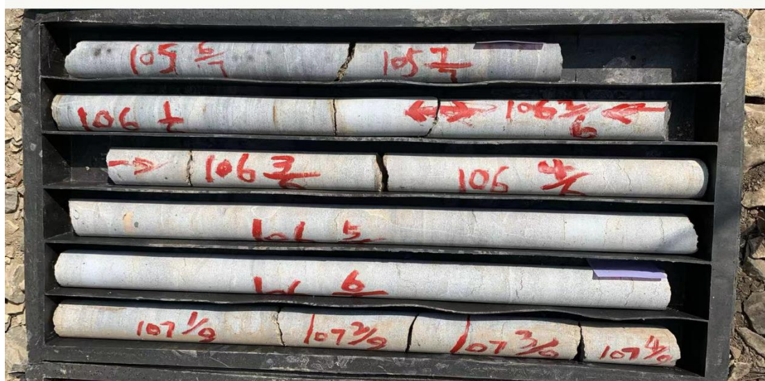
张夏组第一段 ZK202 钻孔岩芯照片 (孔深 285.2m~289.8m)
