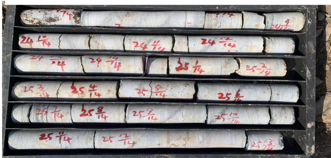
崮山组第二段 ZK406 钻孔岩芯照片（孔深 54.1m~58.7m）
