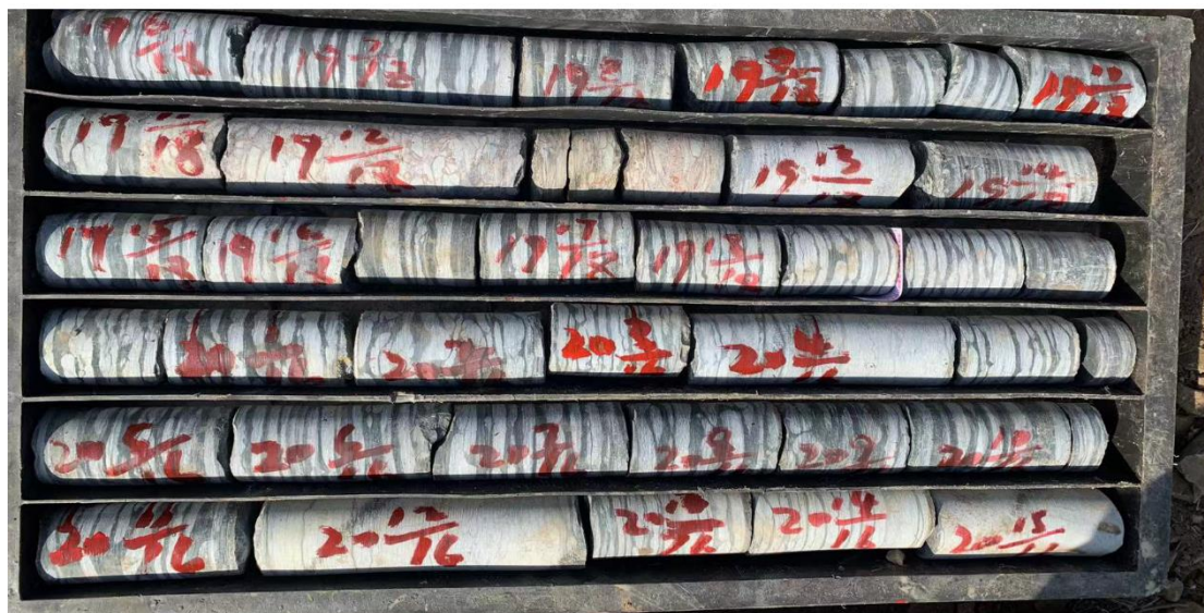
崮山组第三段 ZK406 钻孔岩芯照片（孔深 39.9m~44.5m）
