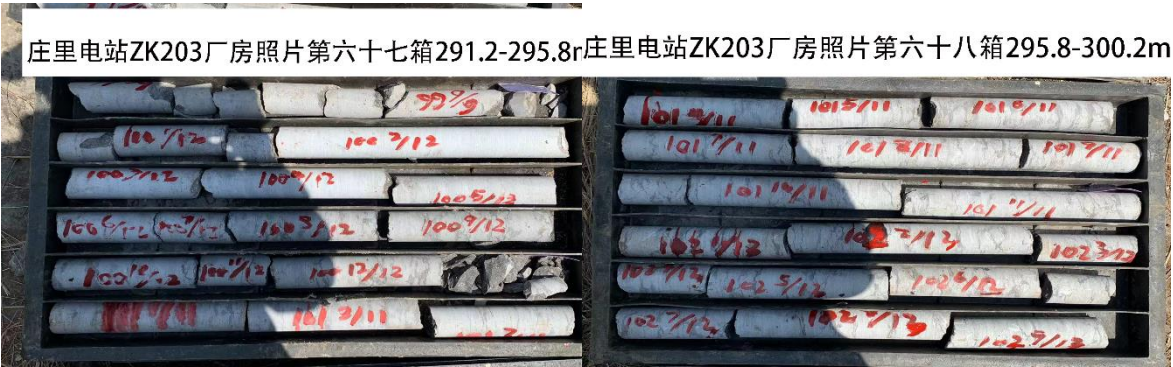
图 4.6.3.1-1 厂房钻孔岩芯照片（ZK203）
