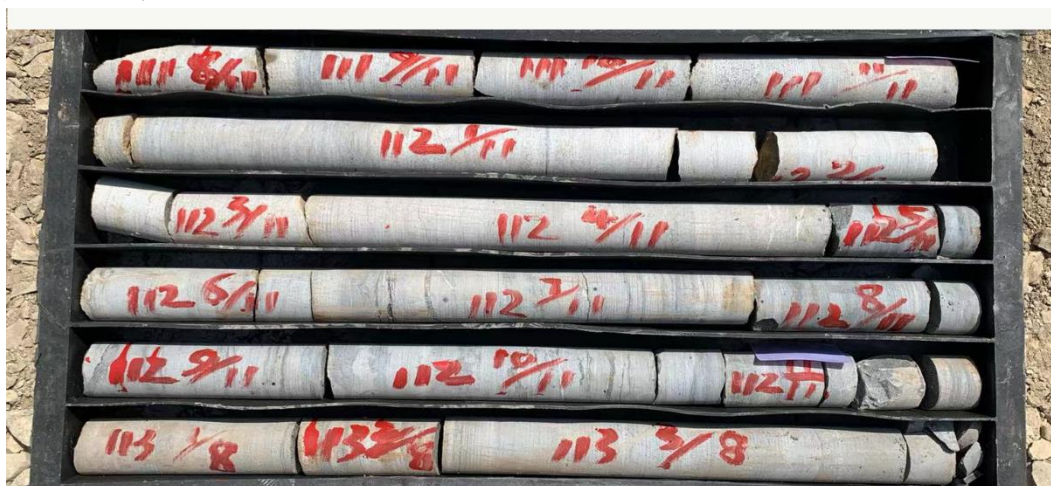
馒头组第四段 ZK202 钻孔岩芯照片（孔深 303.2m~308m）
