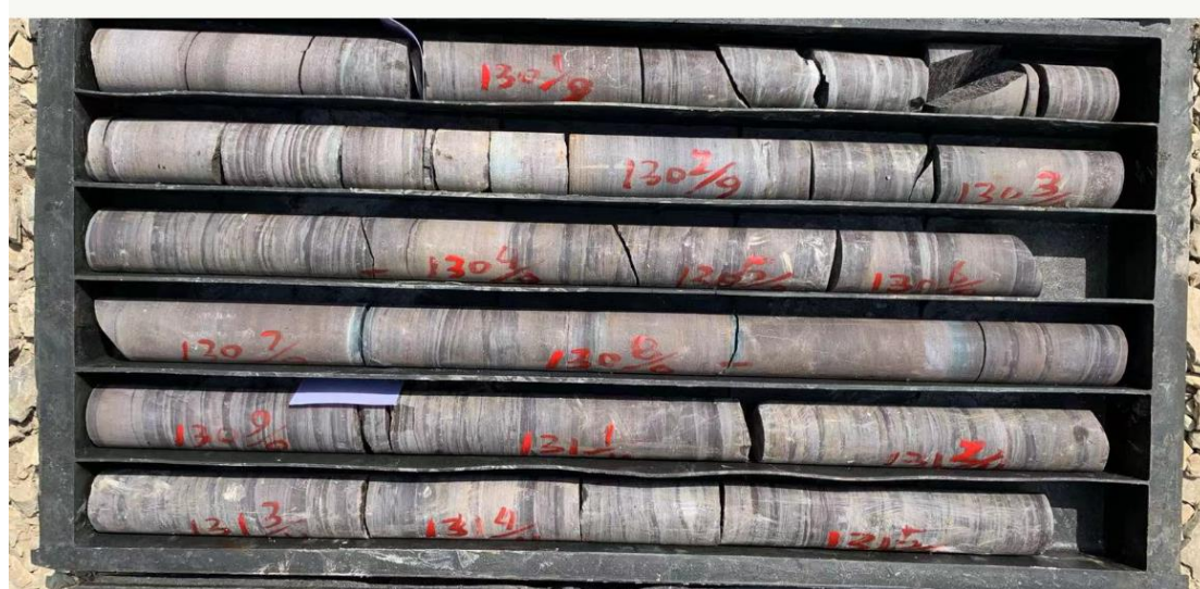
馒头组第一段 ZK202 钻孔岩芯照片（孔深 357.8m~362.1m）
